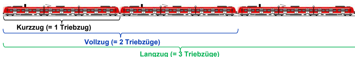
Abb. 1: Mögliche Zugbildungen bei der S-Bahn anhand einer Prinzipdarstellung
